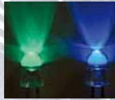
실리콘기판상에 제작한 질화갈륨계 반도체를 이용한 청,녹색의 발광다이오드
